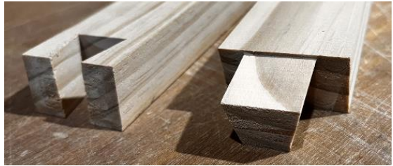
6. 貫穿鳩尾榫製作完成
